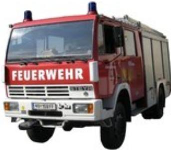
RLFA 2000 - Rüstlöschfahrzeug mit Allradantrieb und 2000l Wassertank Steyr 13S21 4x4
