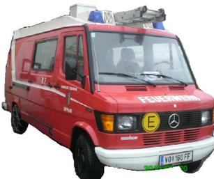
KLF - Kleinlöschfahrzeug mit einer Tragkraftspritze Mercedes Benz
